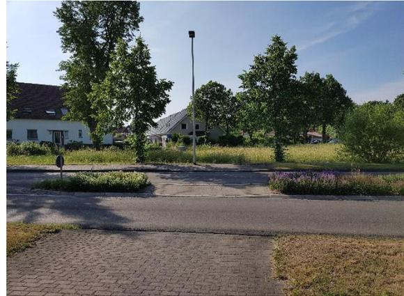
**Planung:** Prüfung des Baus eines asphaltierten Geh- und Radwegs mit einer Mindestbreite von 2,5 m, der die Querungshilfe über den erkennbaren Trampelpfad an die Straße Esch anbindet. Abzuwarten ist zunächst eine mögliche Veränderung des Trampelpfads durch die Errichtung des geplanten Kreisverkehrs am Knoten Hilterweg / Brockhagener Straße.
