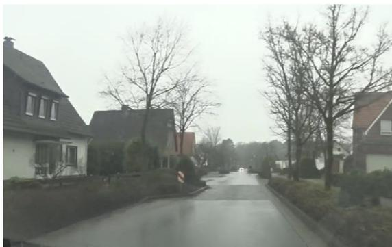
**Planung:** Durch die hohe Netzrelevanz ist eine Verdeutlichung der Radverkehrsführung auf der Fahrbahn empfehlenswert. Als kurzfristige bauliche Maßnahme wird eine asphaltierte Umfahrmöglichkeit der Aufpflasterungen empfohlen, weil diese unbequem für den Radverkehr sind.
